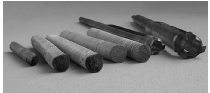
Das Bild zeigt Proben aus Bohrungen, die für die dendrochronologische Untersuchung verwendet wurden.
